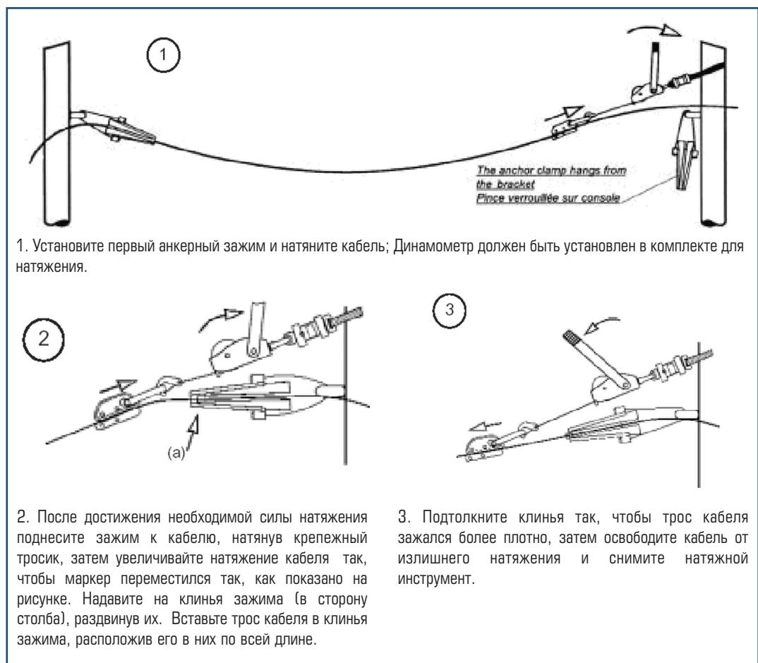
Рис. 2. Способ монтажа кабеля с помощью зажима «МАЛИКРО»
